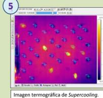
Método dinámico con un tasa de cambio de temperatura de  $\pm 1^\circ\text{C}/\text{min}$  y medida de la temperatura corporal de los individuos mediante termografía de infrarrojos.
